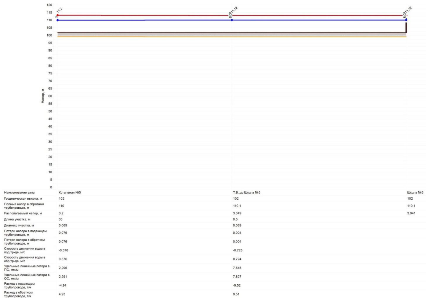
Рис. 3.11. Пьезометрический график работы тепловых сетей «Котельной школа №5»
